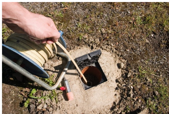
Medición de un pozo de monitoreo dedicado utilizando una sonda electrónica.
